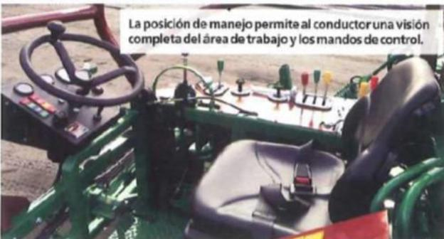
La posición de manejo permite al conductor una visión completa del área de trabajo y los mandos de control.
