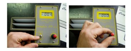
Sucesivamente probar a apagar y encender el instrumento y eventualmente repetir la operación de puesta a cero del mismo.
