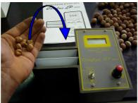
(NB. Es muy importante que el instrumento esté completamente lleno, pero el producto no tiene que estar comprimido o empujado con fuerza).
