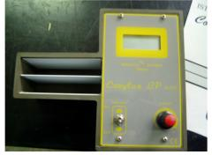
2) Encenderlo, leer el valor indicado que cambiará cada vez, según la húmedad del aire. Llevar este valor a cero "0", usando el mado de reset.
