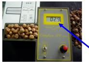
6) Apagar y encender nuevamente el instrumento para controlar que señale un valor bastante constante.
